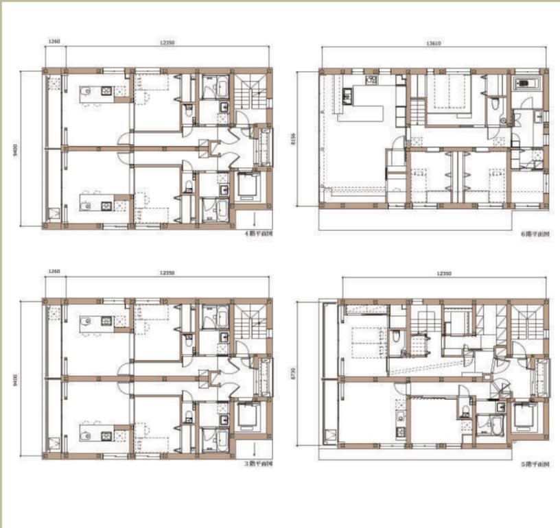
3階～6階平面図 (木造部分)
