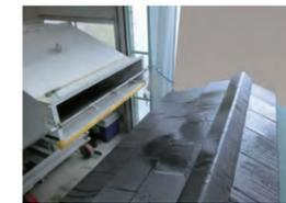
散水量 4L/min 風速 30m/S (10分間) で実施
