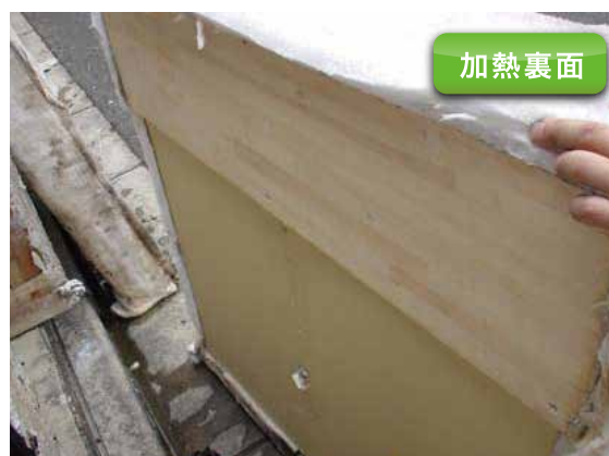
加熱による影響がほとんど見受けられない (野縁をファイヤーストップ構造とした場合)
