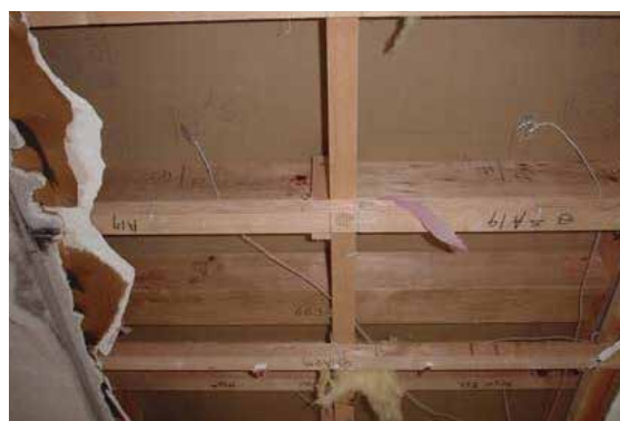
加熱終了後の仕様4(木製野縁)の試験体内部の状態
