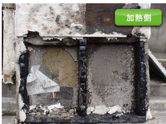
45分加熱後の写真 18分で壁のせっこうボードが破断し始めた (壁体内、木製ファイヤーストップ構造の場合)
