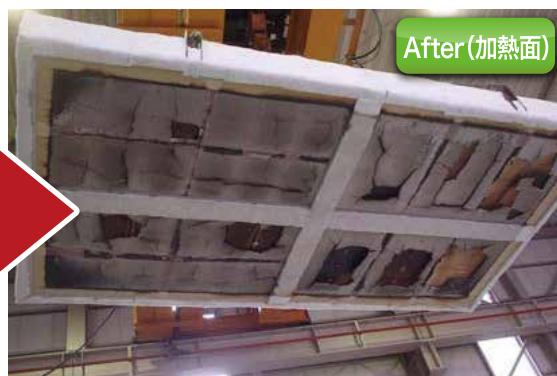
加熱終了後(4種の仕様を同時に加熱した試験体)
