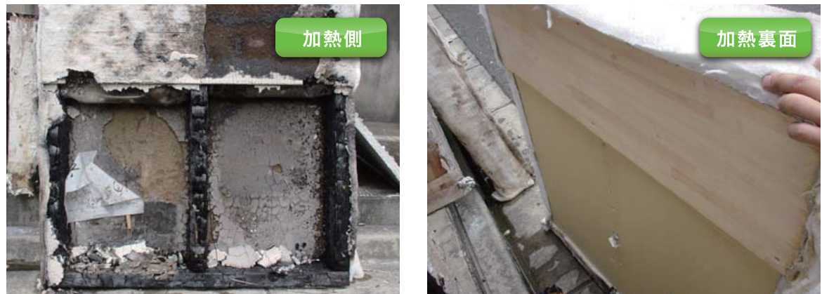
45分加熱後の写真 18分で壁のせっこうボードが破断し始めた (壁体内、木製ファイヤーストップ構造の場合)
