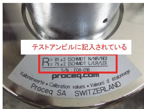
写真-4 テストアンビルの反発度
