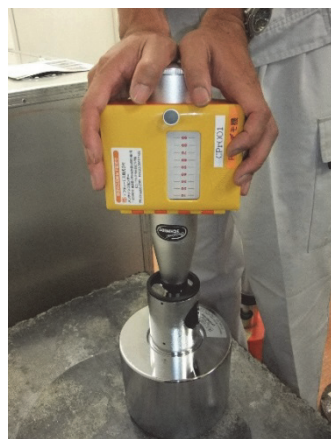
写真-5 テストアンビルによる点検状況
