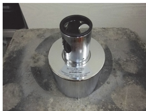
写真-2 テストアンビルの例
