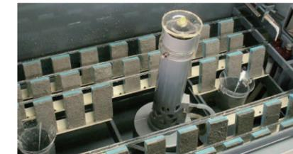
塩水噴霧・乾燥・湿潤を繰り返し、大気腐食を促進して再現する試験。鋼板腐食やその他建材の相性による腐食を確認します。
