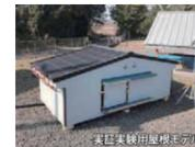
通気層の効果を実証試験により確認しました。浸入水や結露水・湿気などを滞留することなく排出できる構造です。屋根全体の耐久性向上につながる性能です。
