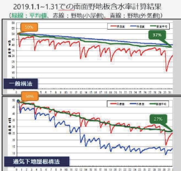
通気構法の野地平均含水率は1カ月で約半分の27%となっています。（一般構法は37%）。特に外気側は通気層に接しており、透湿ルーフィングを通して速やかに乾燥していることが分かります。小屋裏側については一般構法、通気構法ともに差はなく、十分な小屋裏換気を設ける必要があります。
