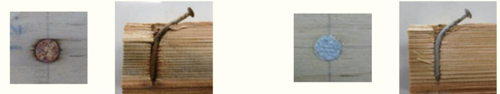
\* JIS B 7920:2000湿度計-試験方法：恒温器と硫酸カリウムを用いた飽和塩法を利用して、高温環境をつくり、釘を強制的に錆びさせた。その後せん断試験を実施。
