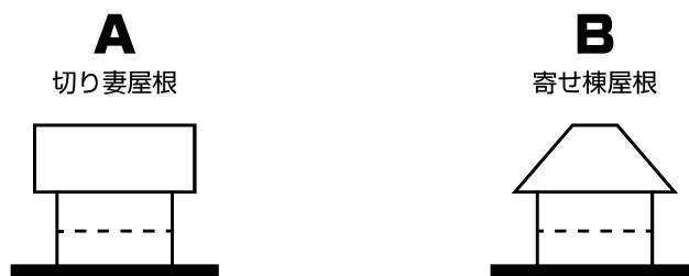
屋根形状により必要壁量が増える
