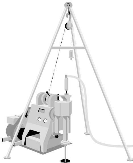
図12-3 ボーリング調査試験機
