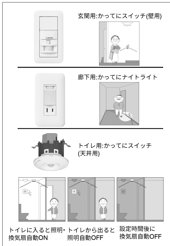
図47-1 屋内用の熱線(人感)センサー式自動スイッチ
