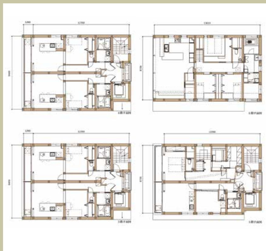
3階～6階平面図(木造部分)
