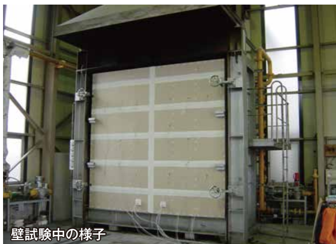
壁試験炉。試験体セットの様子
