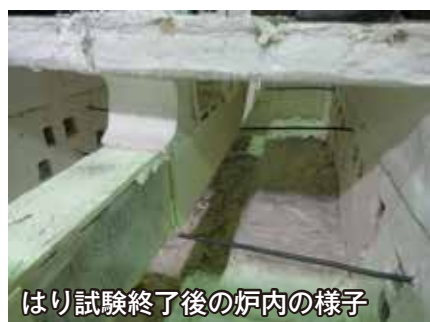
はり試験が終了して脱炉後の様子
