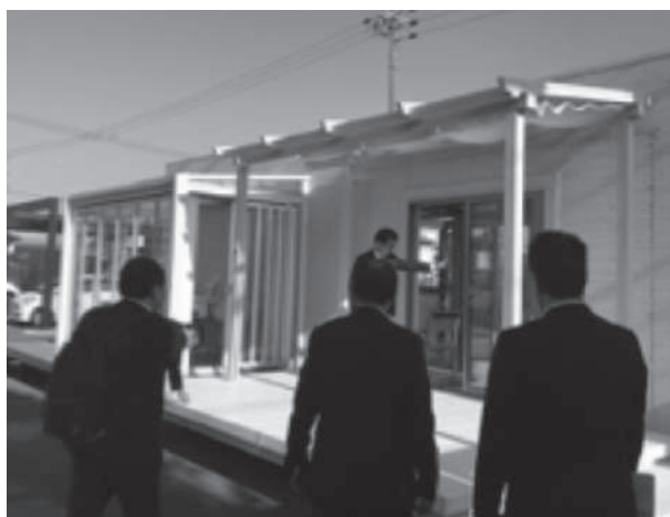
エクステリアデザインの一部を切り取った展示品。耐候性を高めたウッド調デッキとフラット敷居を持つサッシの組合せである。屋内外の間位置に、新しい空間を創出してくれる。
