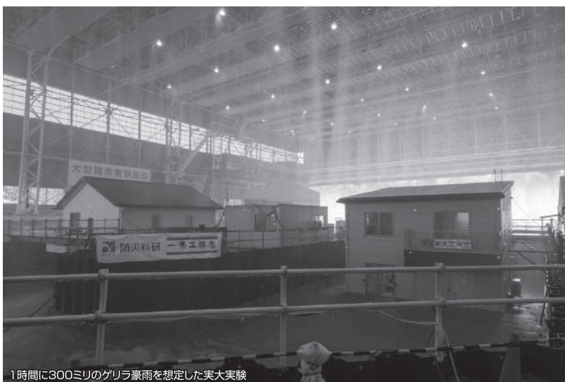
1時間に300ミリのゲリラ豪雨を想定した実大実験
