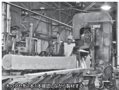
木のクセを1本1本確認しながら製材する
