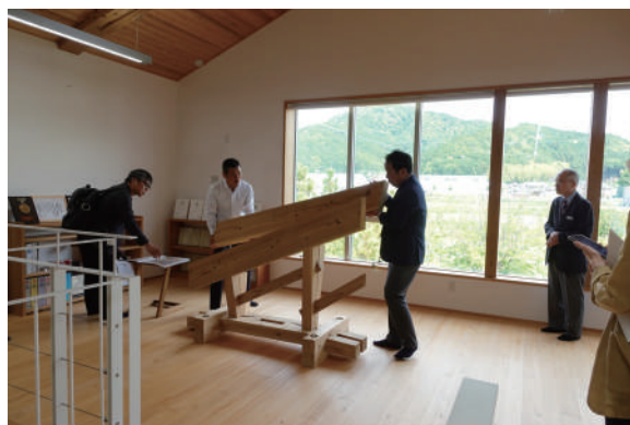
検証のためにつくられたハーフアーチ構造のモックアップを展示。検証により、接合金物を用いない木組みが採用された。各部材は抱き合わせることで材幅を大きくし、水平にかかる力に抵抗するように設計
