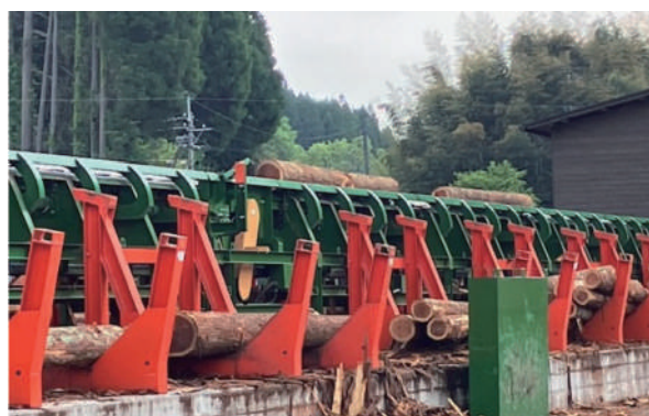
レールを流れてくる原木 等級の場所で振り分けられる
