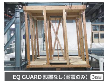
3回目で筋かいが破損
