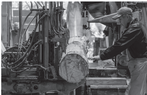
「野村材木店」にて、丸太を角材に製材する作業を見学
