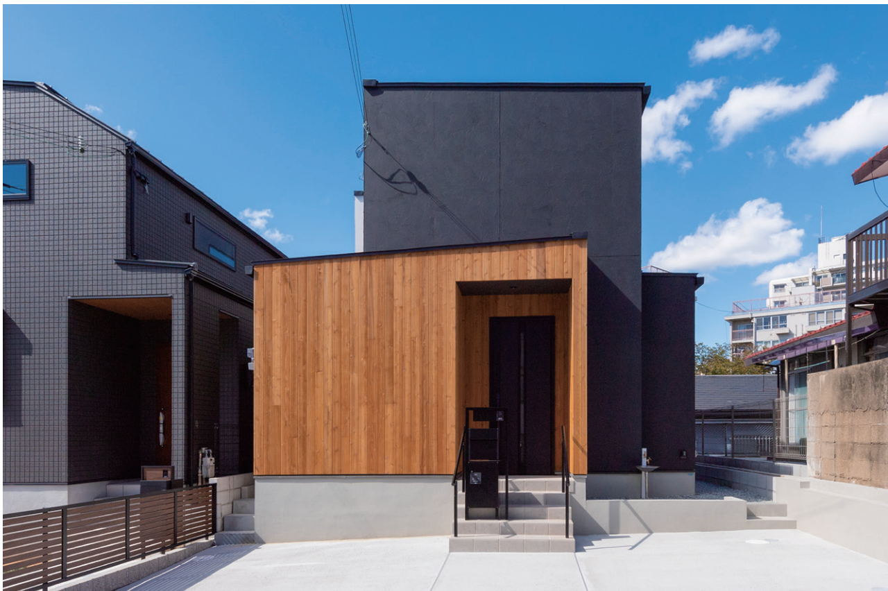
天然木のサイディング「ウィルウォール」と真っ黒な塗り壁「ジョリパット」を使ったスマートなデザイン。
